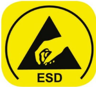
Statische Aufladung entsteht bei jeder Bewegung bzw. bei jeder Arbeit. Dieses Phänomen kennt man als ESD (=Electro Static Discharge). Wird statisch aufgeladenes, leitendes Material berührt, wird dieses Potential schnell entladen und mit hoher Wahrscheinlichkeit ein ESD-Schaden verursacht. Dieser muss nicht immer sichtbar sein. Er kommt meistens zustande, ohne dass er bemerkt wird, denn die Wahrnehmungsgrenze liegt erst bei 3000 V.
